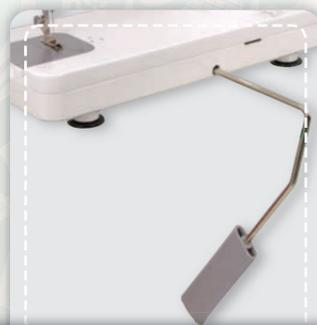
**Kniehebel:** Durch ihn kann der Nähfuß bis zu 12 mm, ohne Benutzen der Hände, gehoben oder gesenkt werden.
