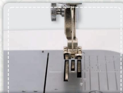
**Stahltransporteur:** Projekte von schweren bis hin zu leichten Stoffen lassen sich sehr gut transportieren und garantieren einen leichten Nähbeginn.
