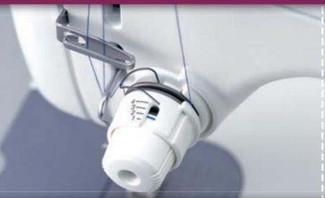
**Manuelle Fadenspannung:** Die Maschine verfügt über eine stufenlose Einstellung der Fadenspannung. So kann die Spannung entsprechend dem Garn und Material angepasst werden.
