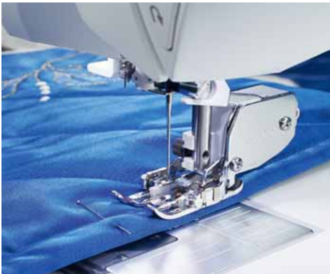
Der wechselbare Obertransportfuß gewährleistet einen gleichzeitigen und exakten Stofftransport von oben und unten. Optimal z. B. zum Nähen von Stoff und Vlies – nichts kann sich verschieben.
