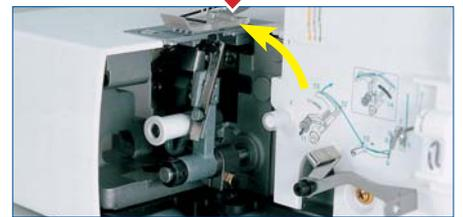
Einfädelhilfe für den unteren Greifer.
