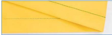
Ein-Nadel-Zwei-Faden-Doppel-Kettenstich zum Bandeinfaßen, zum Zusammennähen gewebter Stoffe und für dekorative Effekte.
