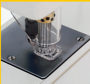
Nadelkopf mit 12 Filznadeln, einzeln austauschbar
