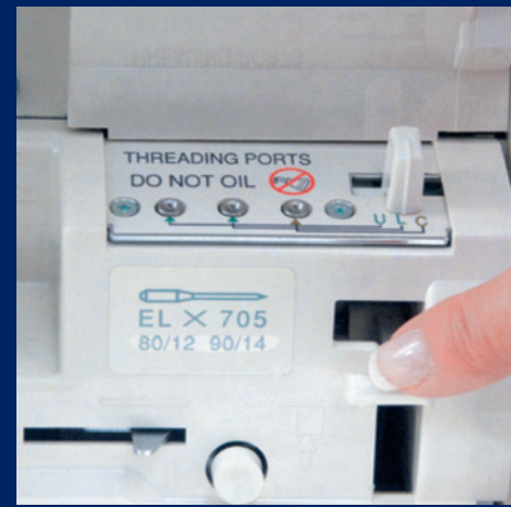
Jet-Air-Greifereinfädelsystem. Einfach genial!!!
