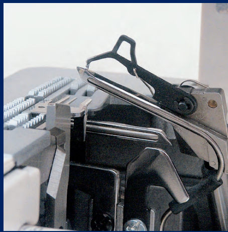
extrastarke Greifer mit schwenkbarem Hilfgreifer
