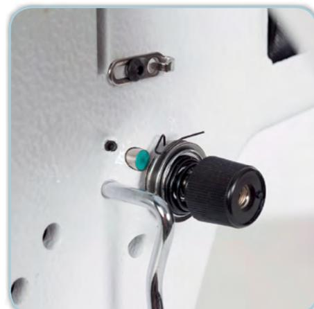
Digitale patentierte Fadenspannungseinstellung
